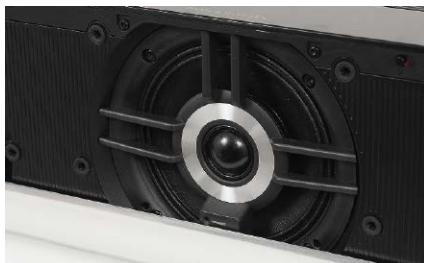
Układ koncentryczny jest znakomitym rozwiązaniem w kanale centralnym.
