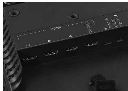
Panel przyłączeniowy podzielono na dwie sekcje; w bardziej „typowej” znajdują się cztery gniazda HDMI (w tym jedno z kanałem zwrotnym).
